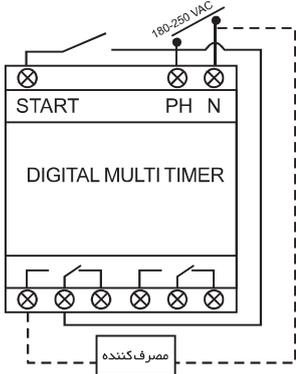
**توجه ۲:** از وصل کردن مستقیم بارهای خازنی یا سئوچینگ یا درایورهای LED به دستگاه به دلیل جریان بیش از حد راه اندازی در این نوع مصرف کننده ها، خودداری گردد. در این موارد الزاماً از رله خارجی یا کنتاکتور مناسب استفاده گردد.
