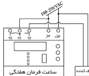
**تذکره ۹:** این دستگاه برای مدار فرمان طراحی گردیده و برای مصرف کننده هایی با جریان بیش از 2A میبایست در کنار دستگاه از رله کمکی یا کنتاکتور استفاده شود.
