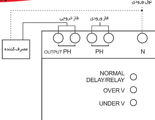
حال می توانید فاز مصرف کننده را به ترمینال های خروجی وصل نمایید حتی المقدور برای اتصال سیم ها از کابلشو مناسب (پهن) استفاده نمایید.
